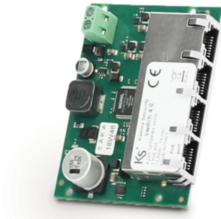
switch 4.0 è uno switch di rete 10/100Mbit pensato per il collegamento delle centrali lares 4.0 con le tastiere touchscreen ergo-T & ergo-T plus. Dispone di 4 porte di rete di cui una PoE (Power over Ethernet) che può essere utilizzata per collegare direttamente una ergo-T o ergo-T plus. Il dispositivo si alimenta direttamente dall'alimentazione della centrale e garantisce quindi un back-up di alimentazione in PoE alla tastiera.
